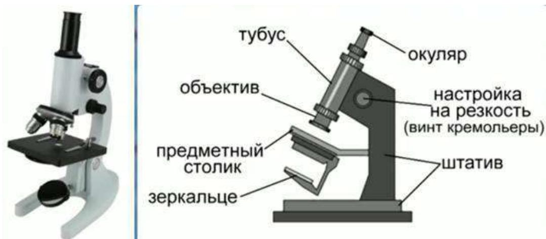
**Рис. 2.** Строение микроскопа
